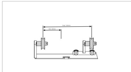
Distancia entre rodillos **min** : 151mm
